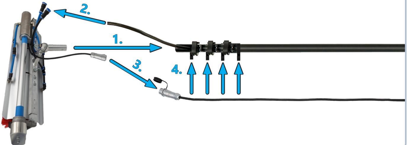
5. Den Schlauch der Teleskopstange mit dem Schlauch der Maschine/Flasche verbinden
